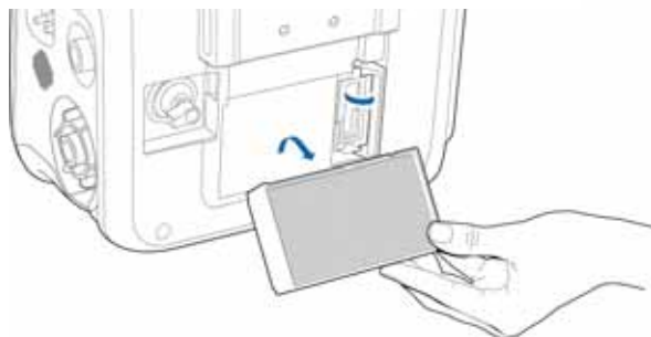
Рисунок 10-4. Извлечение фильтра HEPA
