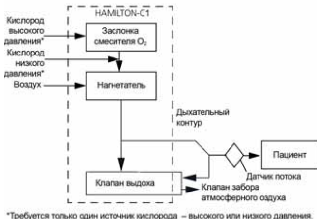
Рисунок 1-1. Подача газовой смеси к аппарату ИВЛ HAMILTON-C1
