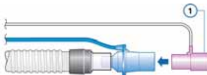
Рисунок 2-12. Крепление датчика CO 2 (1) к воздуховоду
